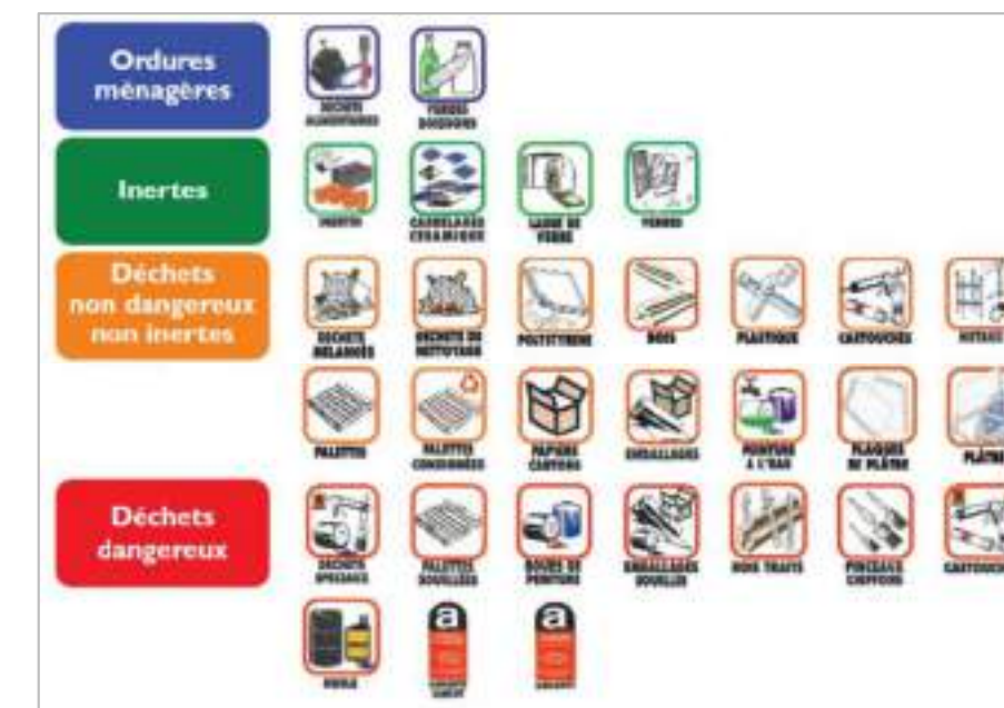
Figure 5-43: Signalétique des déchets de chantier pour faciliter le tri (Source: Internet)
