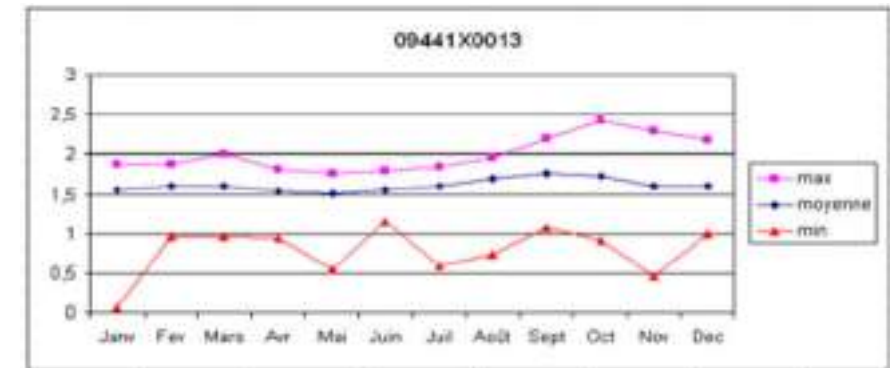
Figure 3-19/ Fluctuations de la nappe en amont de Malijai et aux Grillons
