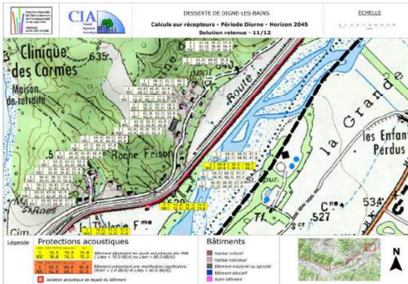
Figure 2-32: Cartographie des calculs sur récepteurs de la solution retenue, effectués à l'horizon 2045 – 1/112 (Source : CIA)
