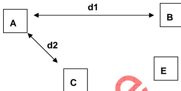
La construction A est non isolée si  $d1+d2 < 100m$ .
