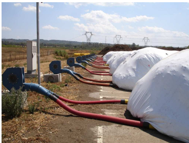
Compostage en andains ventilés confinés
