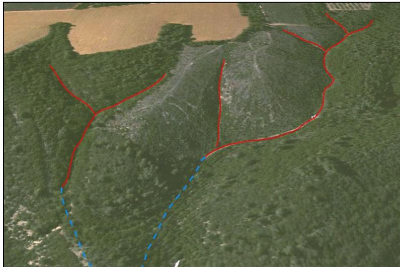
**Figure 17 : Ravinement au niveau du ravin de Beyette [Source : IMS<sub>RN</sub>]**
