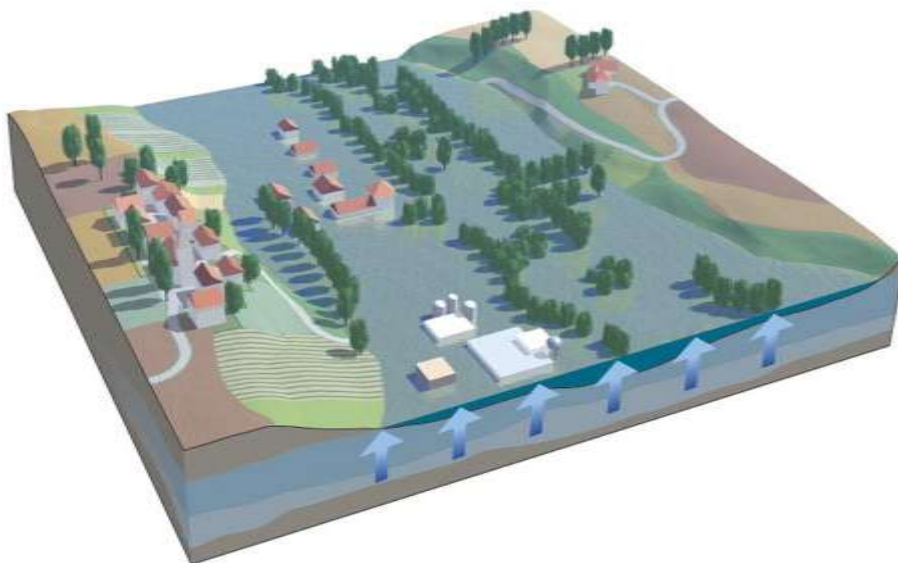
Figure 12 : Schéma de principe d'une inondation par remontée de nappe [Source : www.risquesmajeurs.fr ]
